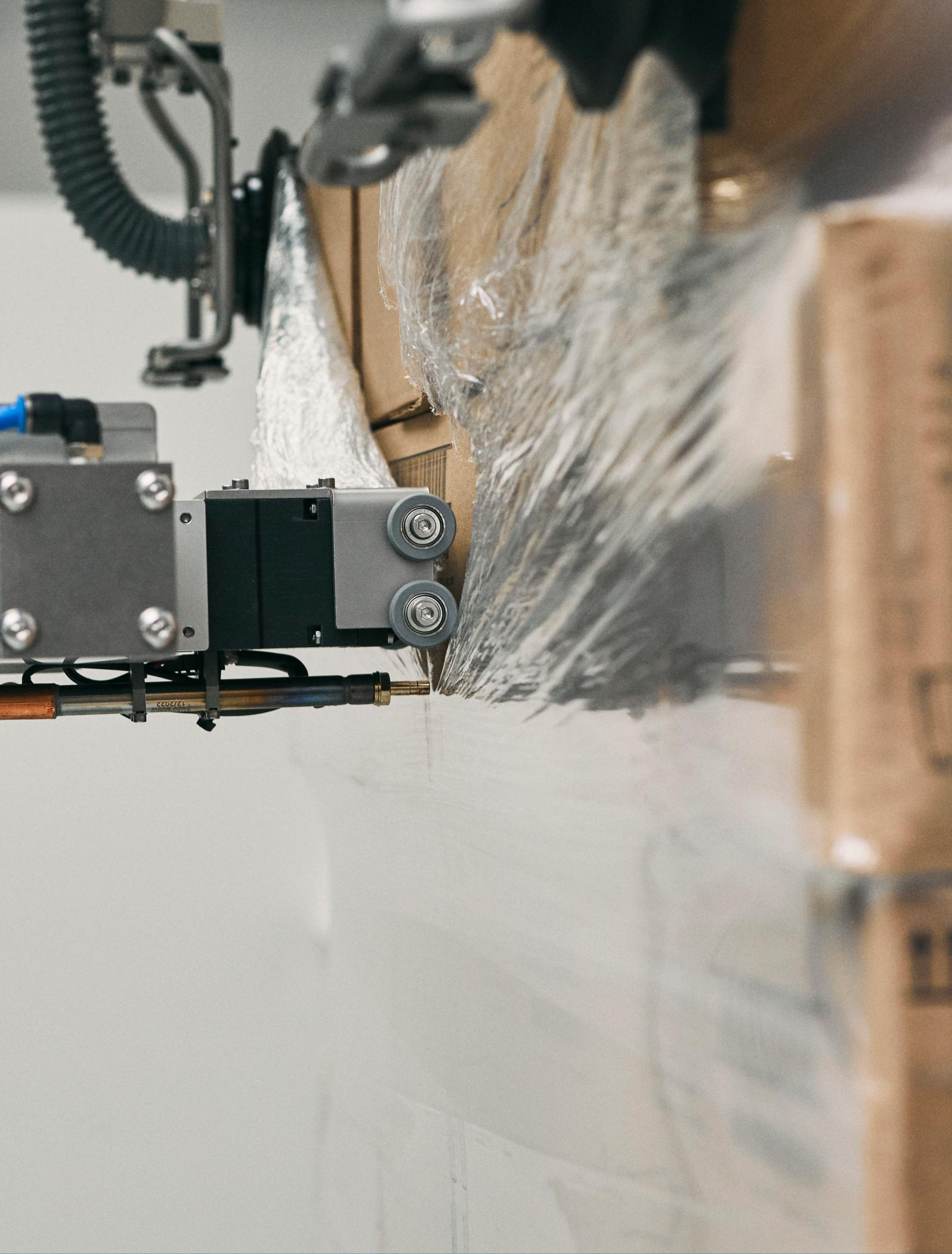
Automatisches Schneiden und Entfernen der Stretchfolie ohne Beschädigung des Produktes
